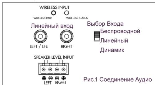
Рис.1 Соединение Аудио
