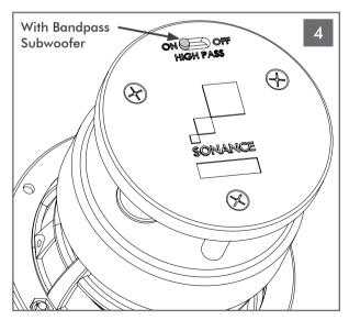
When using AS38RS/BPS6 or AS68RS/BPS8
